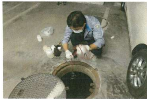
เจ้าหน้าที่เก็บตัวอย่างน้ำเสียไปวิเคราะห์
